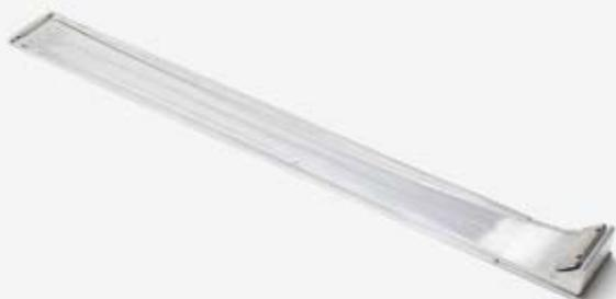
Bloc fraisé CNC (géométrie identique pour le moule de production comme pour le gabarit).
